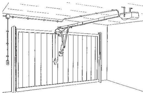
\* Данный тип применения возможен только совместно со специальным рычагом (опция), при этом ворота должны быть корректно сбалансированы, а конструкция достаточно прочной.
