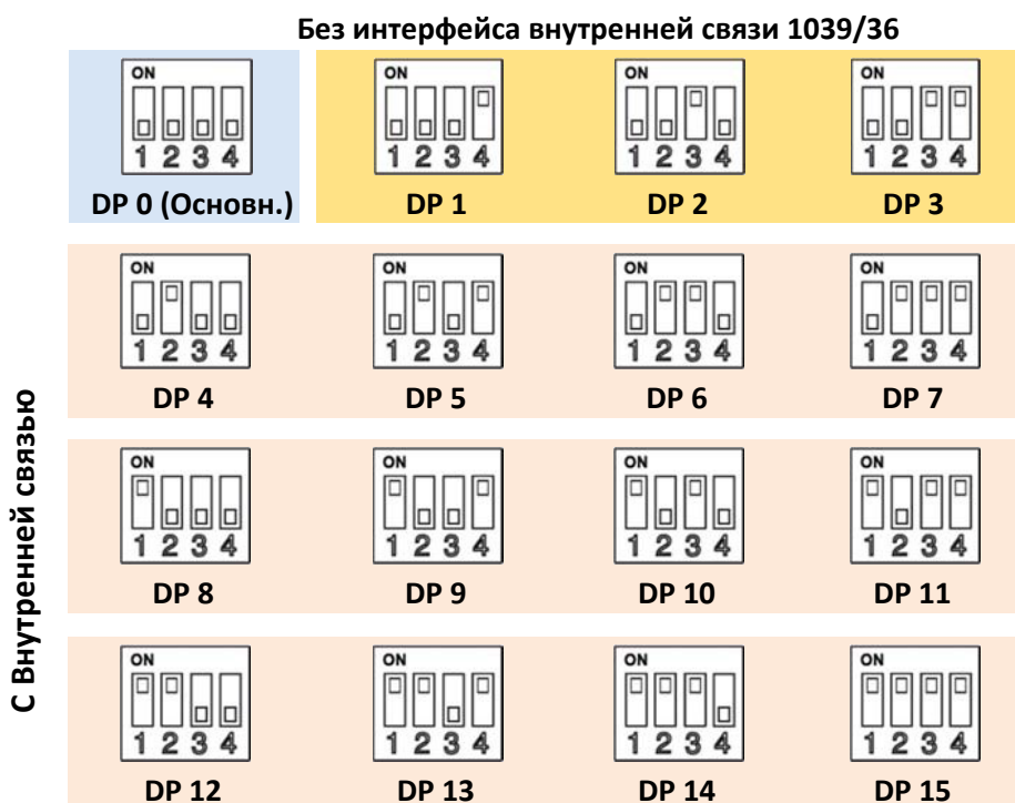
Рисунок 31: Конфигурация абонентских устройств – Dip-переключатель для программирования номера квартирной устройства
