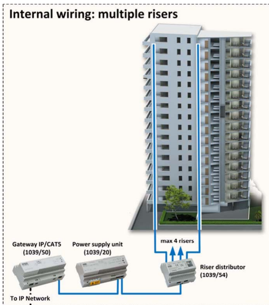
Рисунок 7: Внутренний уровень – распределение на несколько магистралей CAT5
